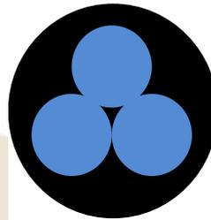
Trenzas de 3 alambres recubiertas con polietileno para evitar el roce del alambre de acero con la malla.
