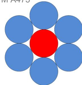
Los cordones para aplicaciones agroindustriales se producen de acuerdo a la norma IRAM 722/84 y se fabrican en formación de 7 hilos (1+6), para ellos se emplea alambre de acero SAE 1050 recubierto por una pesada capa de Zn que cumple con la norma IRAM 777/76.
